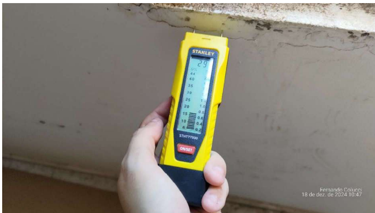
Figura 26 - Detalhe da imagem acima - Umidade medida em 0,7%
