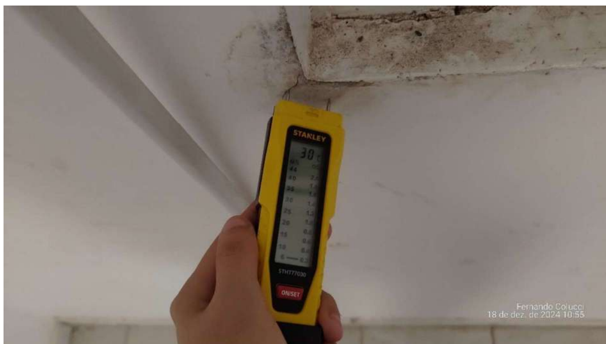
Figura 30 - Detalhe da imagem acima - Umidade medida em 0,2%
