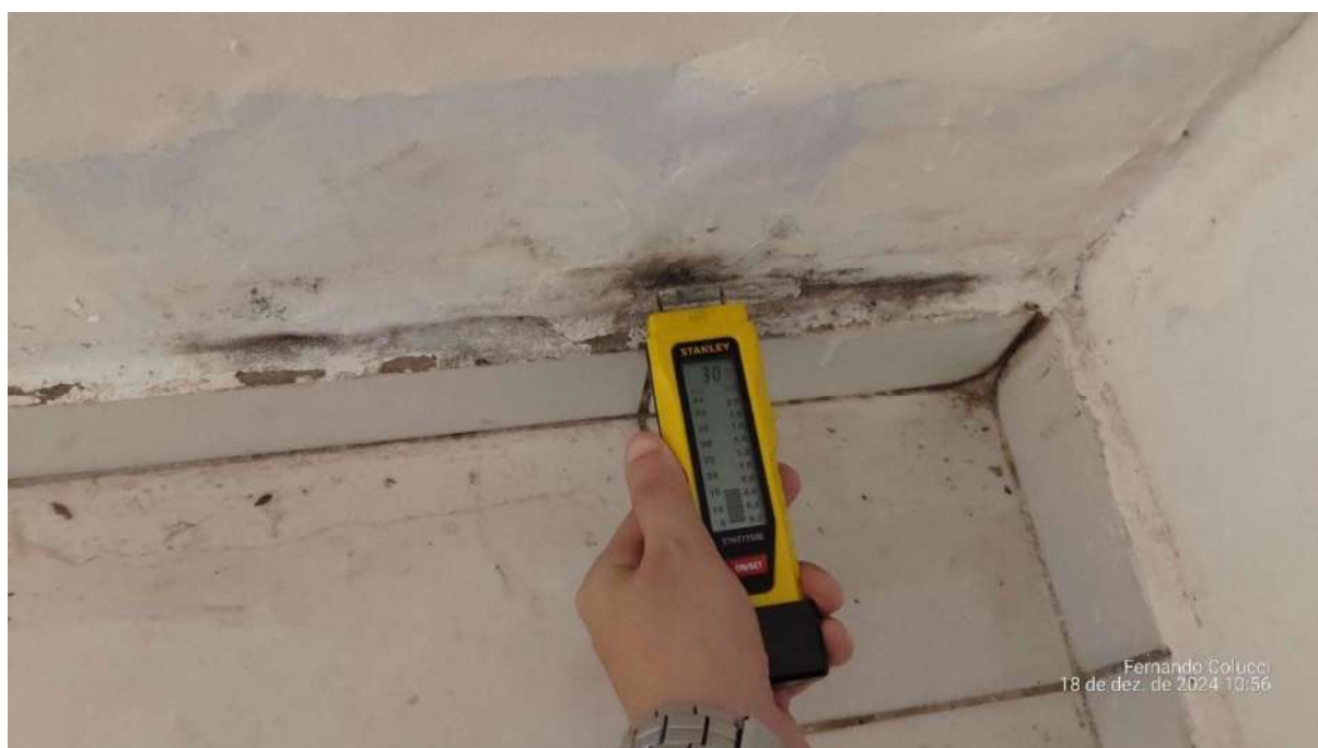
Figura 32 - Detalhe da imagem acima - Umidade medida em 0,7%
